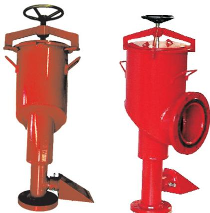
Câmara formadora de Espuma tipo MCS, para ser instalada na parte superior da parede externa de tanques de armazenamento de líquidos inflamáveis. Fabricada em Aço carbono, inclui o selo de vidro, aerador e raquete
