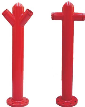
Coluna de Hidrante dupla, fabricada o corpo com tubo de aço carbono 4" e saídas com tubo Ø2.1/2".
