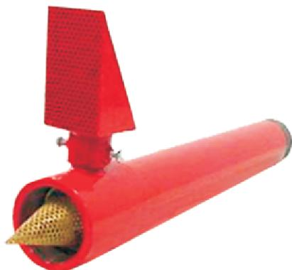
Câmara formadora de Espuma tipo MBS para serem instaladas na parte externa de bacias de contenção de tanques de armazenamento de líquidos inflamáveis. Fabricada em Aço carbono, incluem aerador e placa de orifício e filtro em latão.
